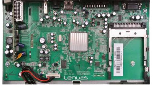
Un unico PCB ospita tutta la circuiteria elettronica del decoder, con la sola eccezione del display, dei comandi (dietro al pannello frontale) e del tuner DVB-S2 (a sinistra). Al centro, coperta dal dissipatore di calore, troviamo la CPU; a destra lo slot CI+; in alto le prese AV e dati (con la Scart sprovvista di schermatura); a sinistra la sezione di alimentazione (accanto al tuner). L'assemblaggio è curato e la filatura pressoché inesistente
