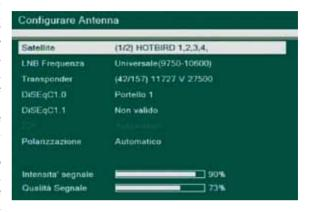
controlla tutte le frequenze presenti nel database. La scansione manuale si effettua dal sottomenu Liste TP, lo stesso che permette di modificare il database (utilizzando, ad esempio, le tabelle digitali di Eurosat) su una delle frequenze elencate con tanto di barre di intensità e qualità del segnale.
