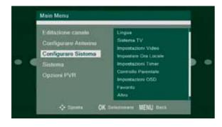
impostare il ricevitore in base alla parabola utilizzata (fissa, motorizzata, con switch DiSEqC o sistema SCR, ecc.), selezionare i satelliti ricevibili, gestire il database dei transponder ed effettuare la ricerca dei canali.
