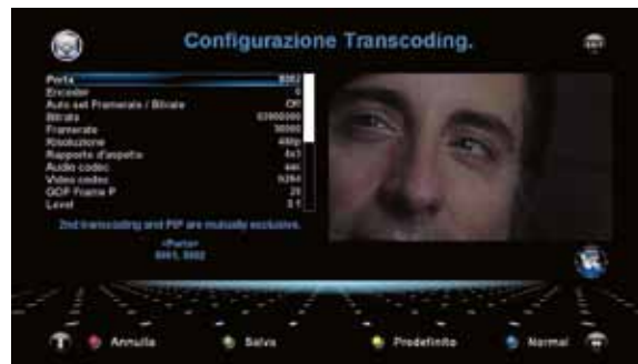
Menu di transcodifica che permette di intervenire sui parametri dello streaming ai fini di rendere più leggero il flusso A/V visualizzato, tramite la rete, da un apparato diverso
