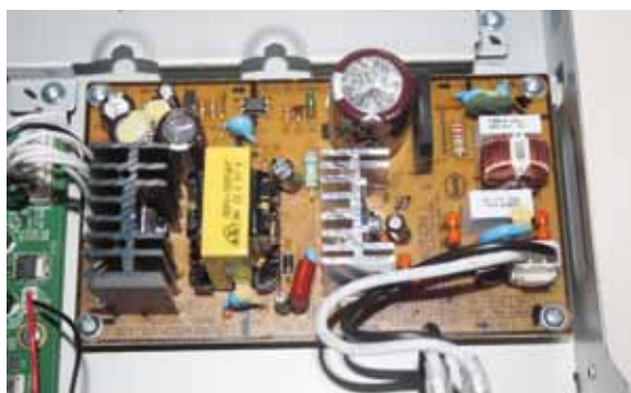
Particolare della generosa piastra di alimentazione in uso sul ricevitore Vu+ Duo2
