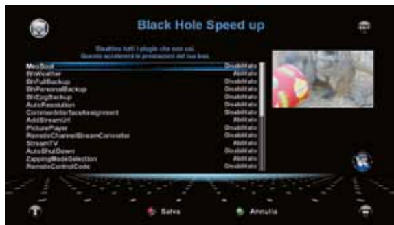
Procedura di speed-up dell'immagine BlackHole: permette di rimuovere plugin preinstallati che si suppone di non utilizzare, allo scopo di velocizzare i tempi di boot e la velocità di esecuzione risparmiando memoria
