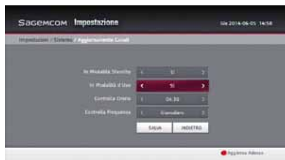
Il ricevitore Sagemcom DSI83HD è capace di aggiornarsi automaticamente via satellite, sia in Stand-by sia durante il normale funzionamento, in orari e con frequenze personalizzabili. Il tasto di colore rosso permette di verificare manualmente la presenza di un nuovo firmware
