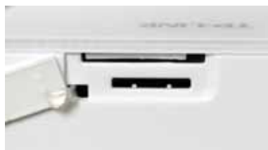
Dietro allo sportellino laterale troviamo lo slot SIM (Full Size) e quello per la scheda di memoria microSD (massimo 32 GB)
