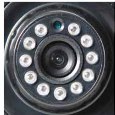
**Il sensore CMOS con risoluzione nativa VGA cattura immagini di buona qualità con un frame rate massimo di 25 fotogrammi al secondo. Intorno all'obiettivo sono montati 11 LED IR che si attivano manualmente oppure in automatico quando il sensore (in alto) rileva un'illuminazione insufficiente**
