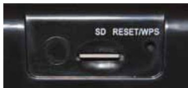
Sul fianco destro è posizionato lo slot di memoria e il tasto Reset/WPS per il ripristino delle impostazioni di fabbrica e l'attivazione della modalità di registrazione automatica Wi-Fi Protected Setup. Lo slot supporta le schede MicroSD fino a 32 GB per registrare lo streaming audio/video in modo continuativo oppure in caso di allarme
